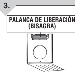
Diagrama 3 Retire la bolsa presionando la traba de liberación.
